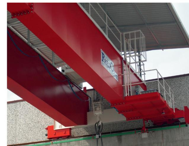
Particolare della testata di appoggio laterale
