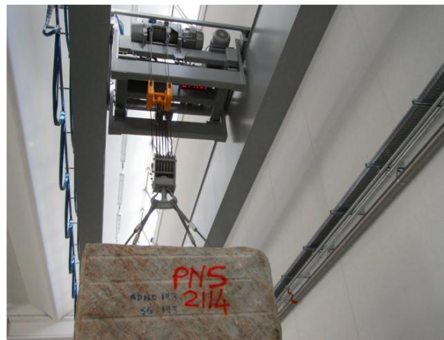
Particolare del carrello di sollevamento con sistema di pesatura
